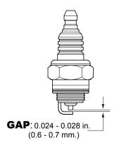
Figure 29. Spark Plug Gap
